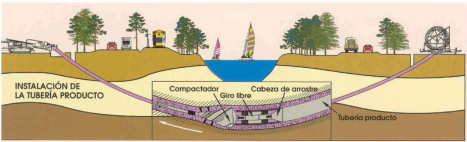
Imagen 6. Fase 3 instalación de la tubería.
